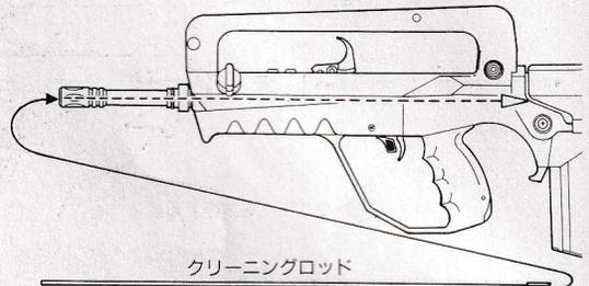
②右図のようにクリーニングロッドの斜めになっている部分が下になる様に注意して、つまっている弾を押し出します。
